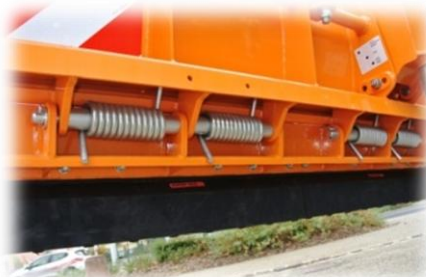
Clapets d'effacement permettant de travailler en toute sécurité
