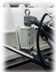
Pivot central renforcé Monté sur une oscillation centrale
