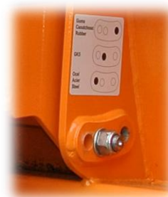
Réglage de l'angle d'attaque
